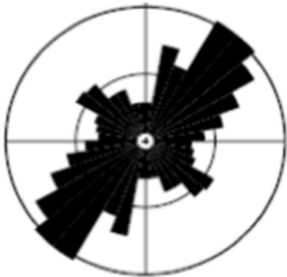
*Fig. 1 - Stazione di misura zona Belvedere - Trend delle fratture nella Calcarenite di Gravina evidenziato dal diagramma a rose.*
