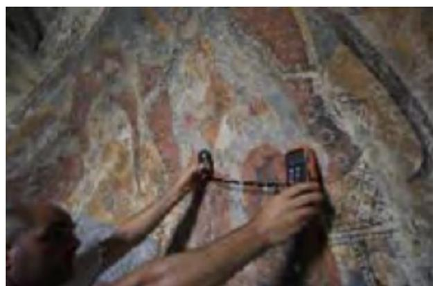
Analisi igrometrica puntuale: per la verifica del contenuto d'acqua nei primi 30-40 mm della muratura. Un  **sensore a corrente elettrica misura la percentuale indicativa dell'umidità contenuta** in
