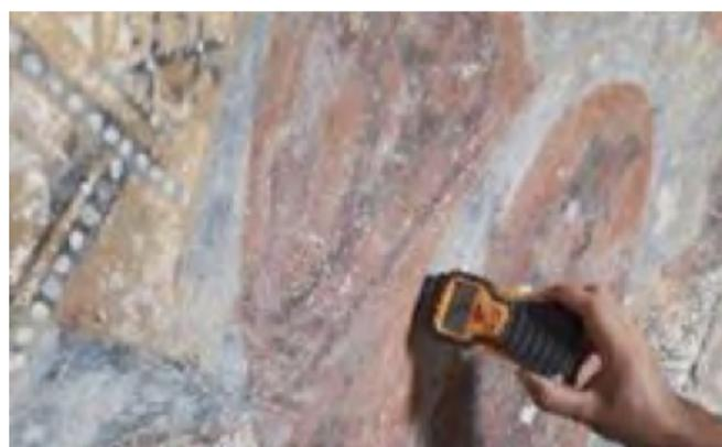
Luxometria: misure dell'intensità luminosa eseguite con strumentazione munita di sensore luximetrico. Alcuni degli ipogei sono caratterizzati da squadri e
