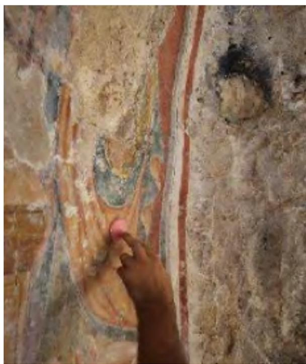
Test di assorbimento d'acqua a bassa pressione con spugna di contatto: per valutare l'igroscopicità dei materiali. l'assorbimento d'acqua è calcolato a partire dalla differenza tra il peso della spugnetta imbevuta di acqua demineralizzata e il peso della stessa spugnetta dopo averla messa a contatto con
