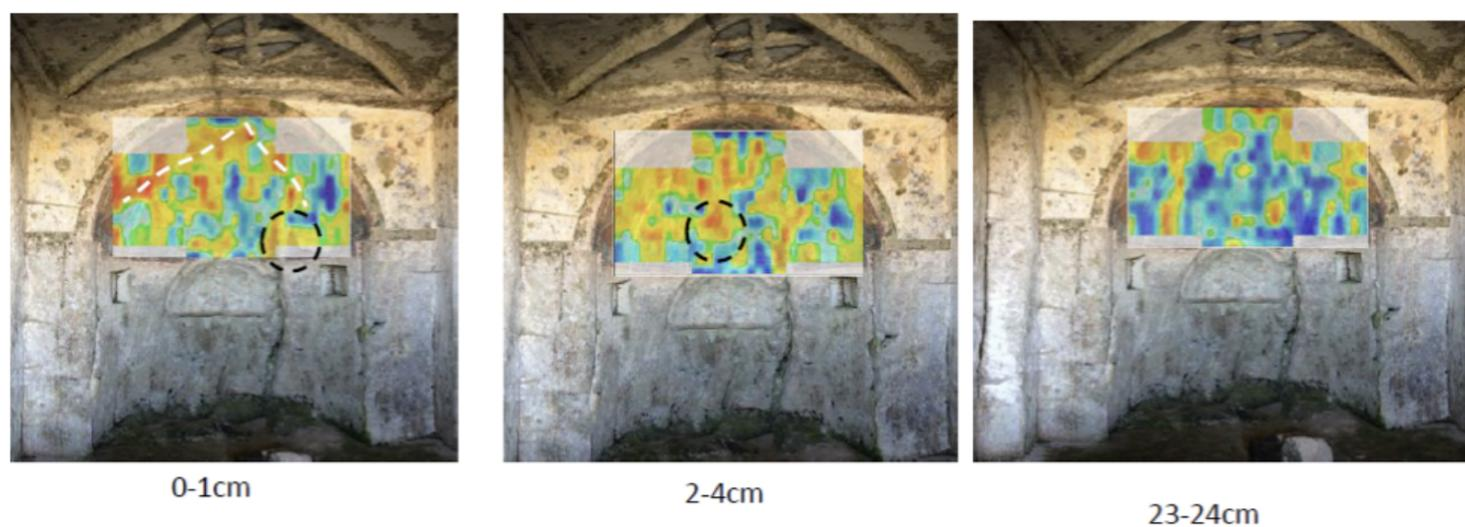
Fig. 24 - Mappe di acquisizione dei dati GPR sull'affresco presente in corrispondenza dell'abside della chiesa della Madonna della Croce, con evidenza delle anomalie (cerchi neri tratteggiati).
